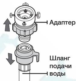
2. С помощью крестообразной отвертки ослабьте четыре винта на адаптере. Затем поверните часть (2) адаптера в направлении, указанном стрелкой, пока не образуется зазор шириной около 5 мм.
