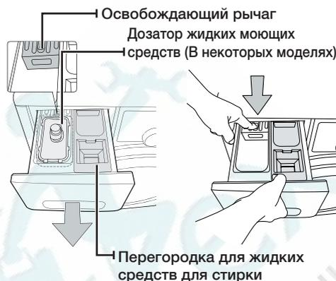
3. Промойте все части отсека проточной водой.
