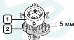
3. Подсоедините адаптер к водопроводному крану и туго затяните винты, поднимая адаптер вверх. Поверните часть (2) в направлении, указанном стрелкой, и соедините части (1) и (2).
