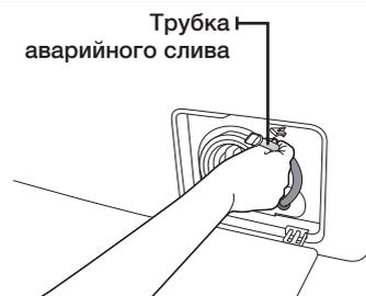
4. Снимите заглушку, закрывающую отверстие трубки аварийного слива.
